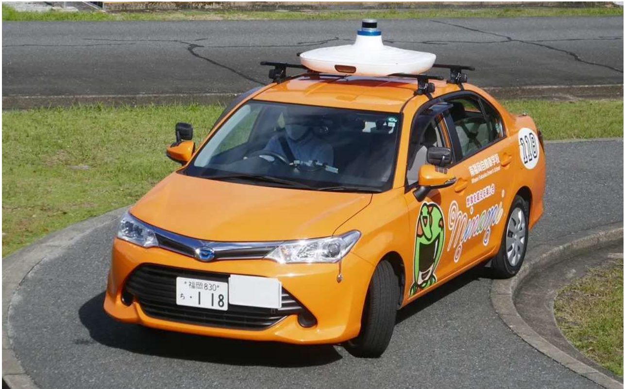
「AI教習システム」を搭載した教習車がS字カーブを走行（撮影:日経クロステック）
